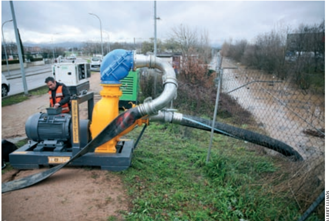
Un operari controla la màquina que treu aigua de les vies totalment inundades a l'entrada de la ciutat de Vic
