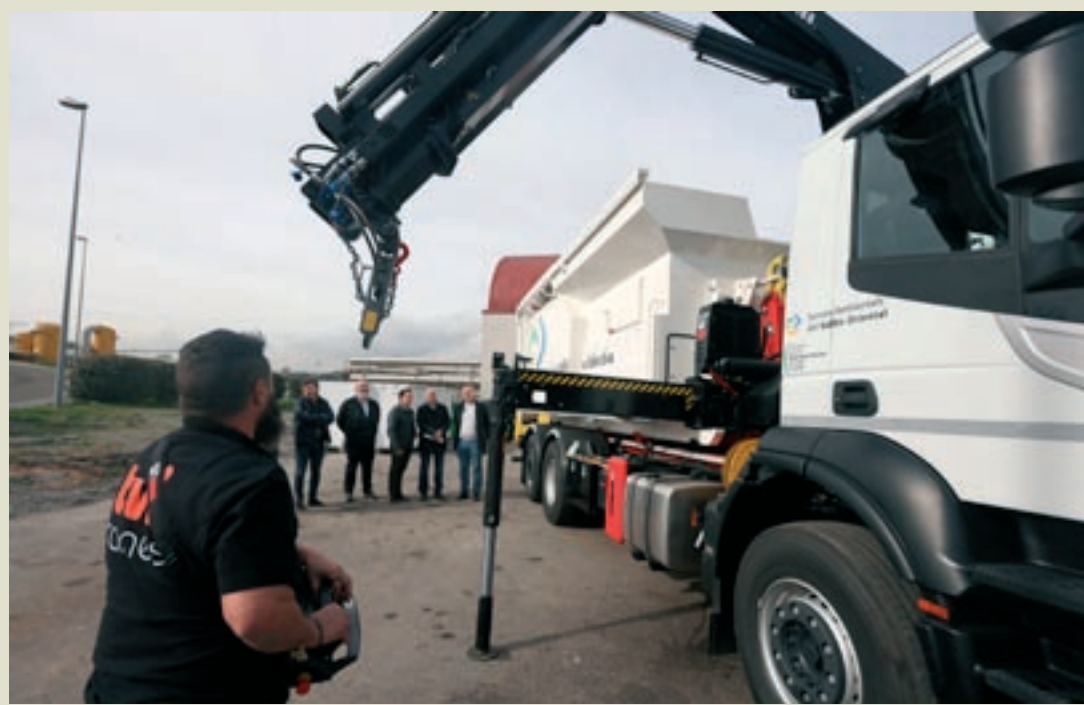
Un operari fa una demostració del funcionament de la grua ploma que ara es fa amb un control a distància
