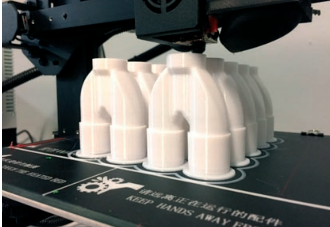
Les derivacions per als respiradors que la firma està imprimint en 3D a la Garriga
