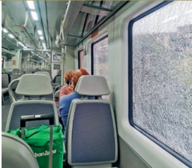
Imatge dels vidres trencats des de l'interior d'un dels vagons
