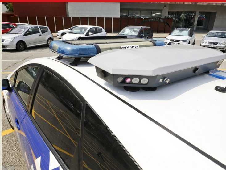
El Multicar, col·locat al sostre del cotxe, enregistra les infraccions
