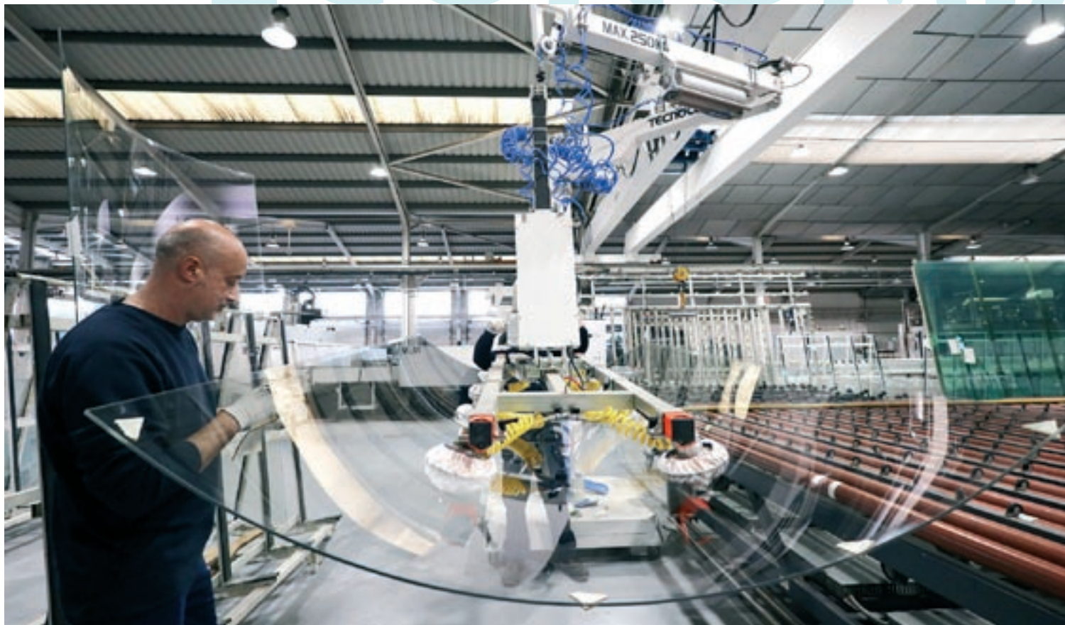
Un operari treballa amb un vidre corbat acabat de sortir dels forns de la planta de SIC (Tvitec-Cricursa) a Granollers
