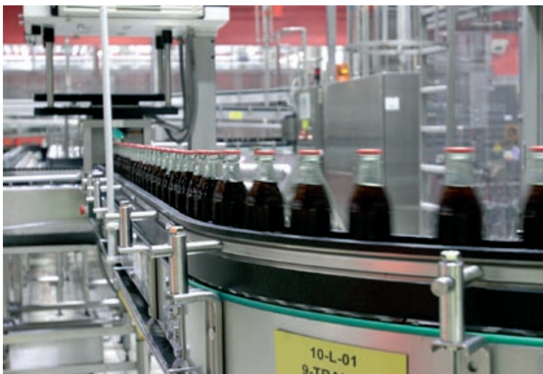
Una de les màquines que omplen envasos de vidre a la planta de Coca-Cola a Martorelles
