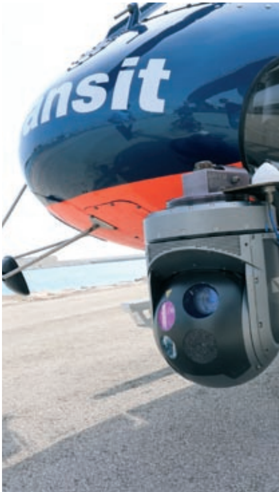
L'helicòpter del Servei Català de Trànsit amb la càmera que permet fer els controls de velocitat a través d'un sistema òptic. Al centre, l'aeronau sobrevolant l'AP-7 al tram del Vallès Oriental i, a la dreta, les pantalles que
